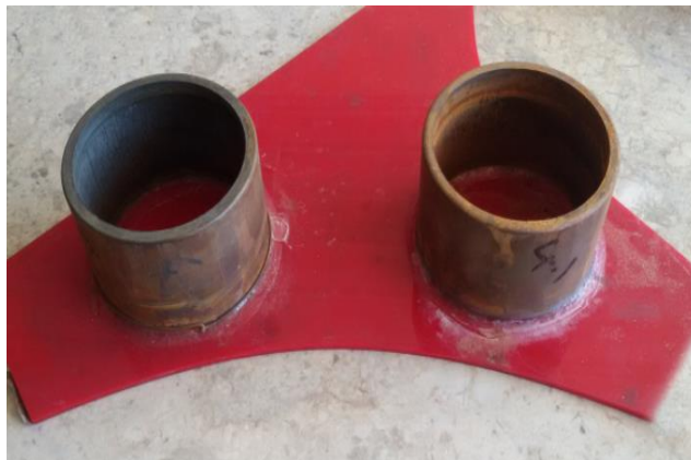
شکل (۹) دو نمونه‌ی لوله‌ای بعد از اعمال خوردگی توسط روش پتانسیواستاتیک آندی
