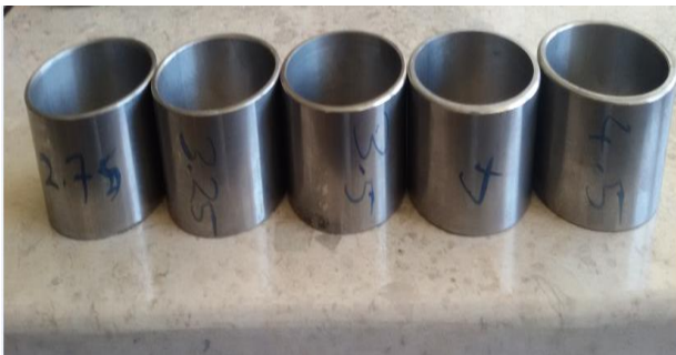
شکل (۷) نمونه‌های تولید شده برای کالیبراسون ادی‌کارنت
